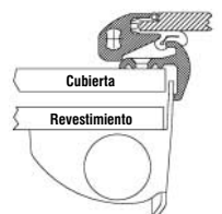
Sección transversal del contramarco con enrolladores
