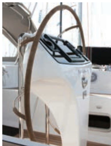
Speziell von Lewmar entwickelter Gunfleet Flightdeck- Steuerstand, mit von hinten montiertem Steuerrad und großer Bildschirmanzeige.
