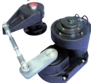
Direkt Antrieb angeschlossen am Hebelarm auf dem Ruderstock mit einer Schubstange
